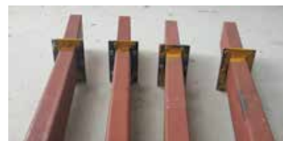
Slika 4. Uzorci pripremljeni za udarno ispitivanje
