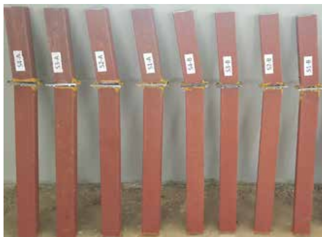
Slika 13. Uzorci nakon udarnog ispitivanja
