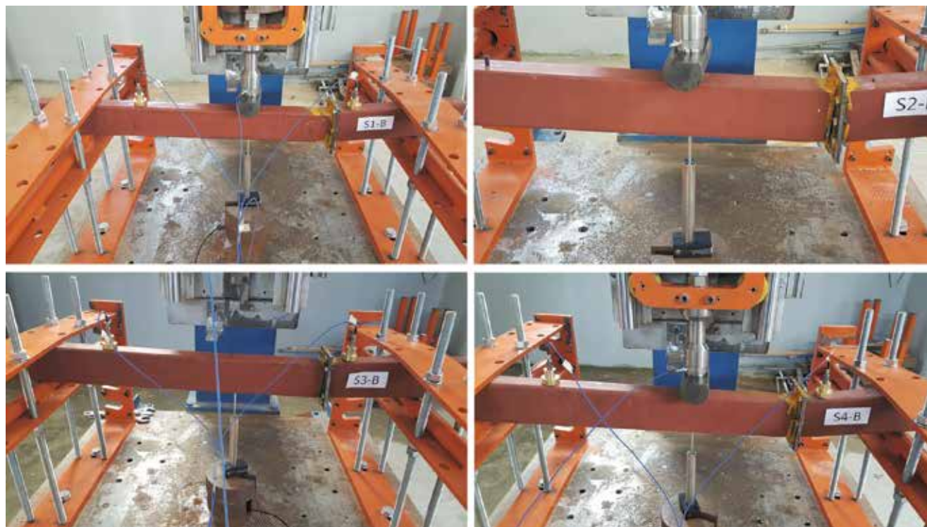
Slika 8. Situacije oštećenja pri slomu uzorka
